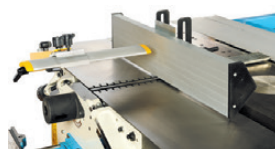
Guide de dégauchissage à 90°
