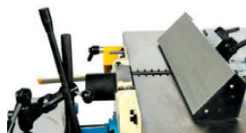
Guide de dégauchissage à 45°
