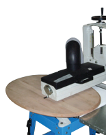
Calibrage "Ouvvert" par retournement de la pièce, largeur de bois supérieur à 410 mm.
