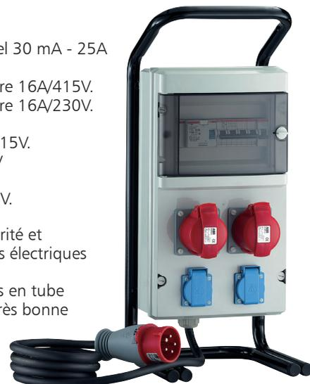
Il est à la fois étanche aux projections d'eau et à la pénétration de la poussière, valeur IP44. Des disjoncteurs divisionnaires assurent la protection contre les courts-circuits et les surcharges. L'interrupteur différentiel assure la protection des personnes.
