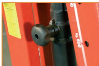
Toutes les grues repliables sont équipées de la commande de descente de sécurité de type "Homme mort".
