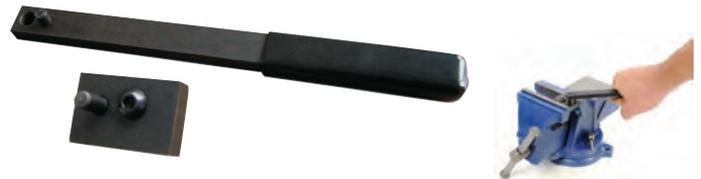
**Utilisation :** Cintreuse simple pour cintrer et enrouler les fils en aluminium, en laiton et en acier inoxydable ainsi que la corde à piano jusqu'à 25 mm. Doit être monté dans un établi pour un bon maintien.
