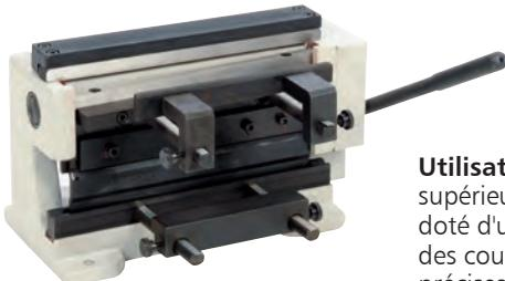
**Utilisation :** La partie supérieure du combiné est doté d'une cisaille réalisant des coupes nettes et précises.
