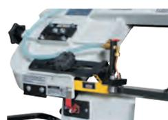
Tendeur de lame et arrosage en direct sur la lame avec arrêt en fin de coupe.
