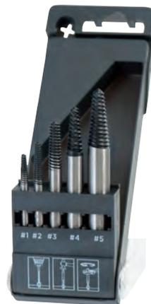
**Utilisation :** Pour extraire des vis, goujons et tronçons de tubes cassés. Percer un trou centré dans la pièce cassée à l'aide du foret recommandé, introduire l'extracteur puis amorcer le mouvement de dévissage de la pièce cassée en tournant l'extracteur vers la gauche (sens anti-horaire). La charge appliquée doit être régulièrement croissante, sans à coups et non brutale, pour parvenir jusqu'au couple maximum admis.
