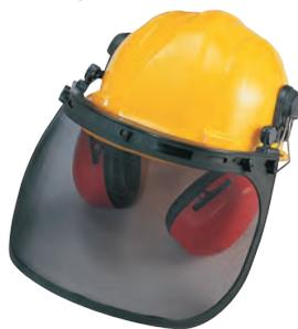
**Caractéristiques :** Ce casque dispose de coquilles anti-bruit amovibles, d'une visière treillis relevable et d'une coiffe plastique à 6 points de fixation. Dimensions : 305 x 192 mm. Indice d'affaiblissement sonore : 23 dB. Conforme aux normes EN397, EN1731 et EN352-1.
