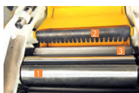
1- Arbre porte-fer / 2- Clapets anti-retour / 3- Entraîneur cranté
