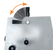
Système de tensionnement rapide qui permet un changement de la lame en un minimum de temps.
