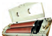
Double cylindre de ponçage, ébauche et finition en un seul passage
